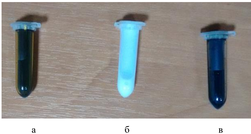
Рисунок 3.2 – Синтезовані суспензії на основі сполук Ag (а), ZnO (б), CZTS (в) для нанесення плівок методом спреї-піролізу
